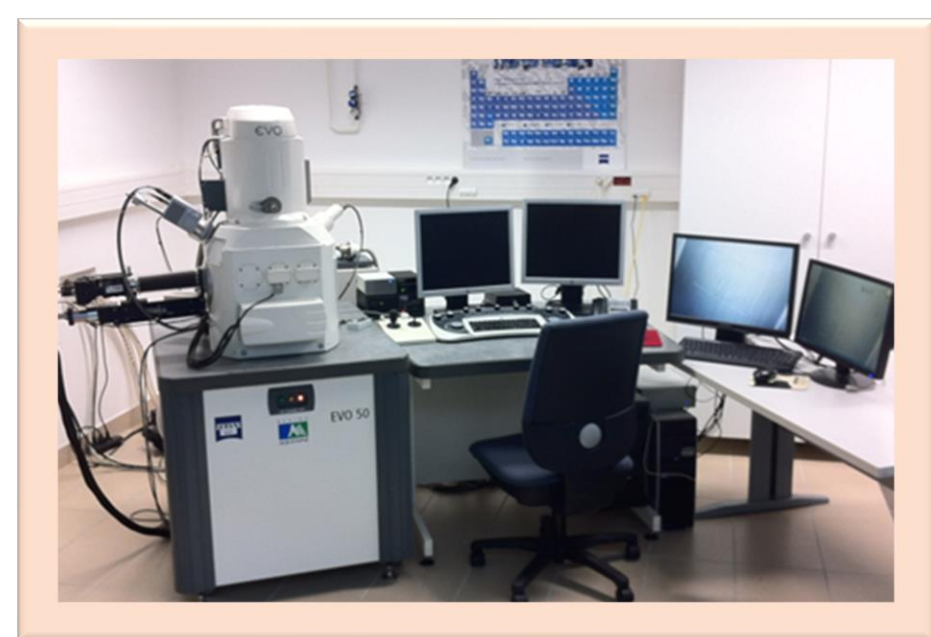
SEM: Zeiss Evo LaB6
